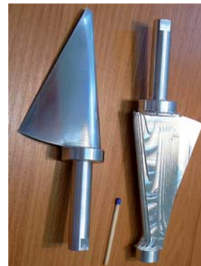
> Lopatka vyrobená na čtyřosém stroji
