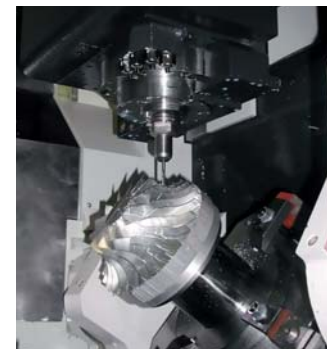
> Výroba kompresorového kola na obráběcím centru Variaxis 500-5X
