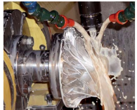
> Výroba radiálního kompresoru oběžného kola
