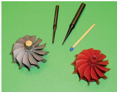
> Voskový model plynové miniturbíny a hotový odlitek
