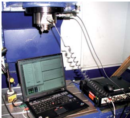
> Měření rozběhu vřetene – dispozice měření
