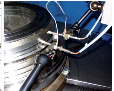
> Bezkontaktní měření vibrací obrobku za rotace
