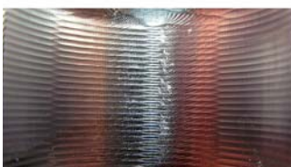
> Porovnání obrobení před a po optimalizaci interpolátoru
