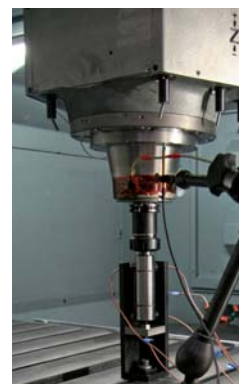
> Měření deformací na fiktivní špičce nástroje
