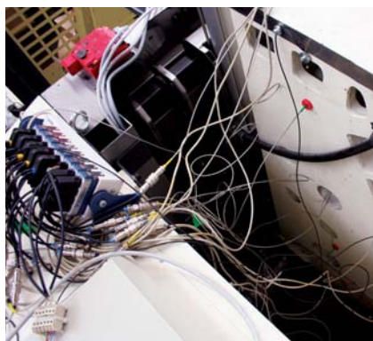
> Umístění teplotních čidel na stojanu obráběcího stroje
