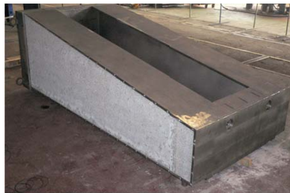
> Ocelový svařovaný stojan se sendvičovými bočnicemi. Jádro sendviče tvoří hliníková pěna.
